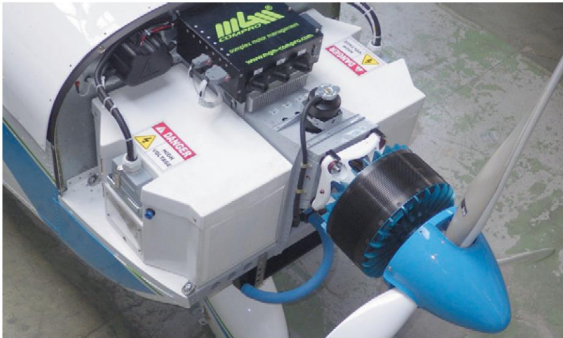
Obr.3 – Detail pohonné jednotky sportovního letadla s využitím superkondenzátorů. (Sport Star EPOS Kunovice)
