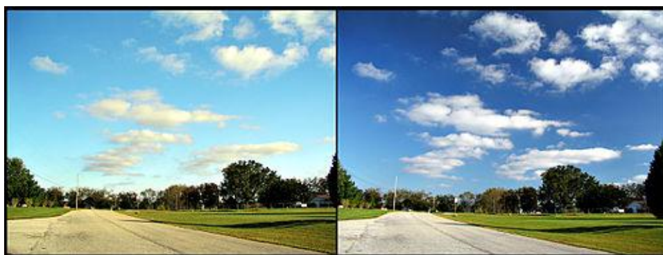
Obr. č. 8 Efekt polarizačního filtru na barevné fotografii oblohy. Obrázek vpravo je nasnímán s použitím filtru.
