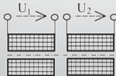
Obr. 16 Princip indukčnostního snímače bez feromagnetika
