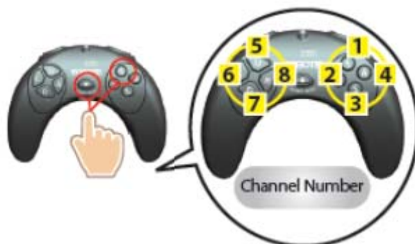
Obr. 3.9 – Volba vysílacího kanálu RC-100 / RC-100A
