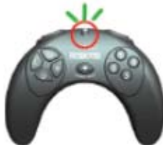
Obr. 3.10 – Počet bliknutí reprezentuje zvolený vysílací kanál
