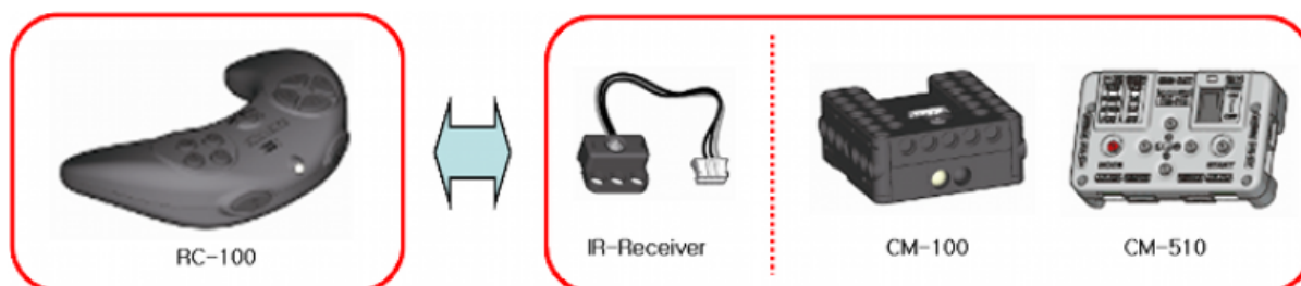
Obr. 3.7 – Princip přenosu dálkovým ovládačem RC-100 / RC-100A
