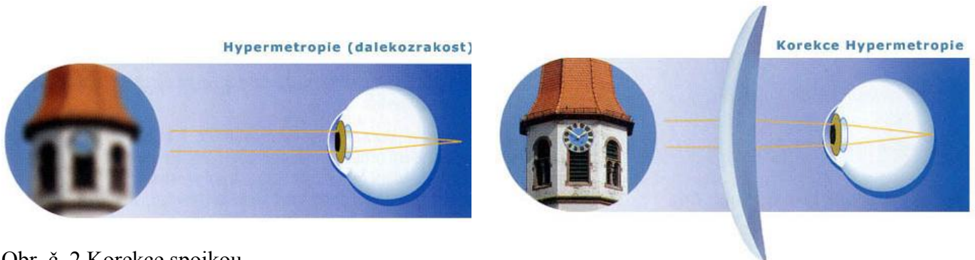
Obr. č. 2 Korekce spojkou
